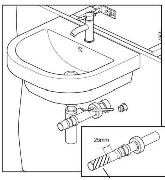
11. Вставьте уплотнитель сливной трубы в выпускное колено. Постройте перегородку, сделав отверстия для болтов и труб как можно меньше. При необходимости выложите поверхность плиткой или нанесите отделку. Смажьте внутреннюю часть уплотнителя сливной трубы и вставьте фитинг сливной трубы раковины в выпускное колено для отходов
