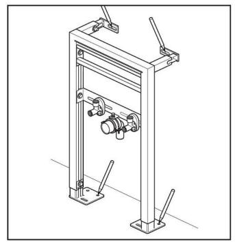
**4.** Отметьте места крепления на стене и полу. Снимите раму и просверлите подходящие отверстия для крепления. Установите дюбели.
