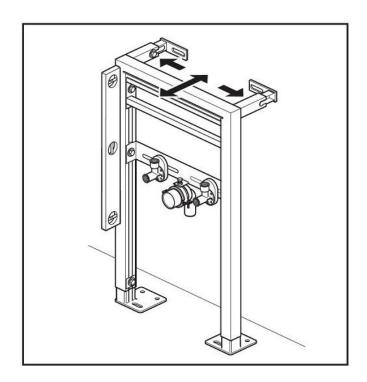
3. Установите необходимое расстояние от стены. Ослабьте болты настенной регулировки, установите необходимое расстояние, проверьте с помощью уровня вертикальность рамы и снова затяните болты..
