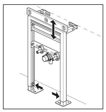
**1.** Спланируйте положение подвесной раковины. Рекомендуемая высота установки раковины 850 мм до верхнего края раковины.
