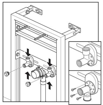
9. Ослабьте патрубки для горячей и холодной воды (используя гайку на задней панели), отрегулируйте требуемое расстояние друг от друга и снова затяните..
