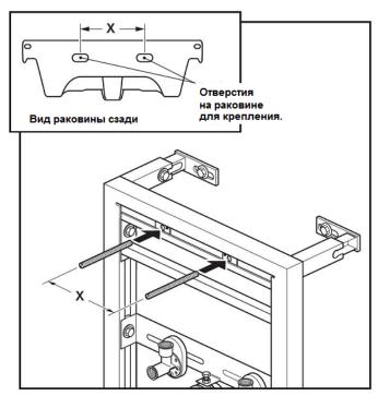
**5.** Измерьте расстояние 'X' между центрами отверстий для крепления раковины.
