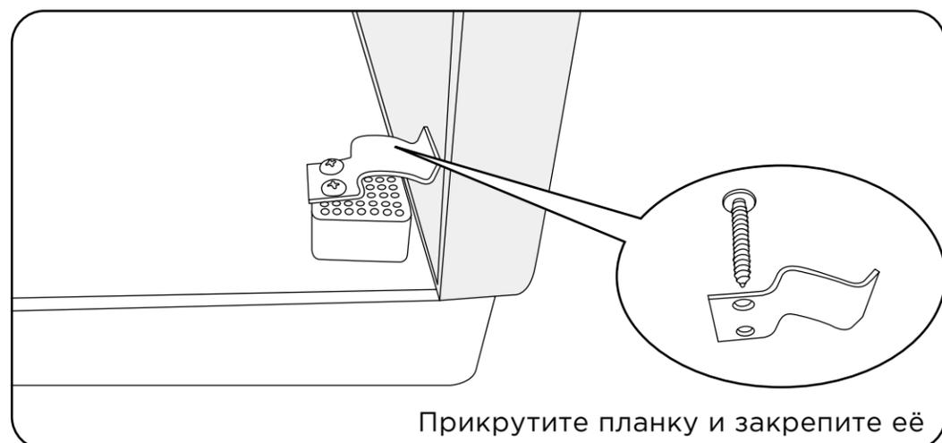
3.2 При помощи крепежного зажима (со стороны экрана), гаек и шайб (со стороны металлического каркаса) зафиксируйте верхнюю часть экрана.
