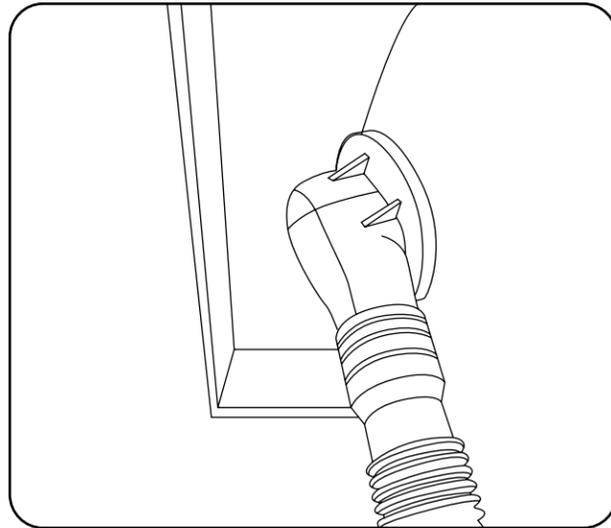
1.2 Установите ответную часть сифона с внешней стороны ванны в сливное отверстие и соедините с внешней частью сливного отверстия внутри ванны.
