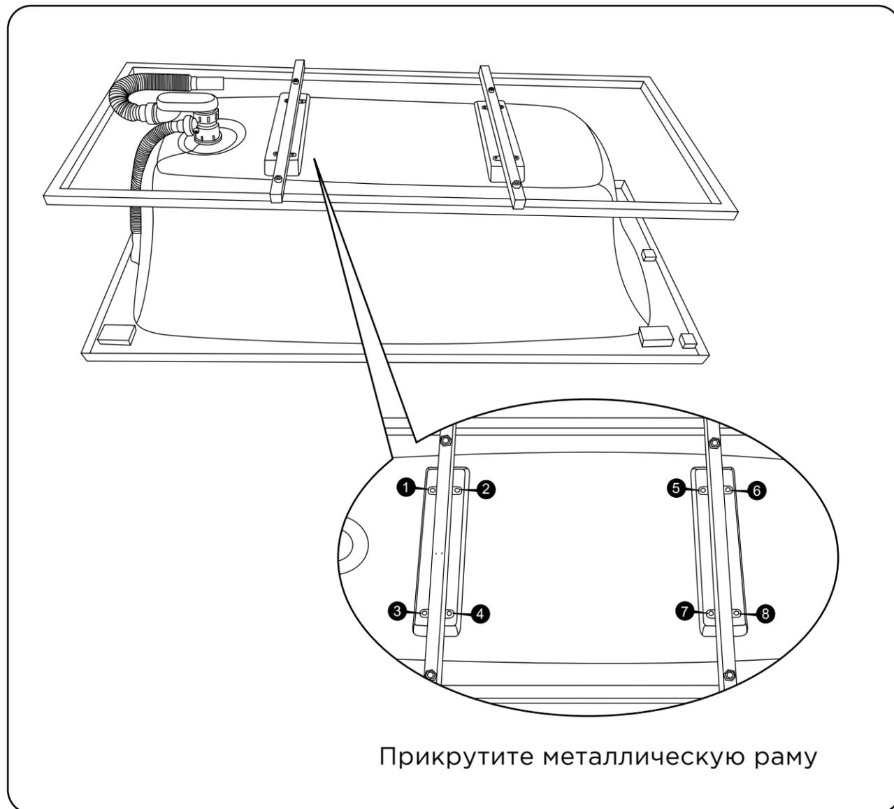
2.2 Накрутите на шпильку 1 шайбу, 2 гайки, 1 нижнюю крепежную планку (всего необходимо 4 шт.), как показано на рисунке ниже. Поместите собранные шпильки в четыре угла ванны и вставьте их в соответствующие отверстия в металлической раме. Нижняя планка крепится к закладной части ванны при помощи винтов.
