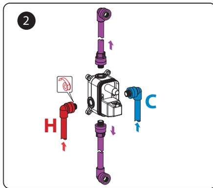
Подсоедините корпус встроенного блока к водопроводу, используя соответствующие фитинги, (C) – входное отверстие для холодной воды, а (H) – входное отверстие для горячей воды.
