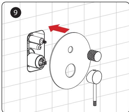
Наденьте декоративную накладку на корпус смесителя. Установите адаптер на шток дивертора и затяните его винтом. Наденьте ручку дивертора и ручку смесителя, зафиксируйте их шестигранными винтами.
