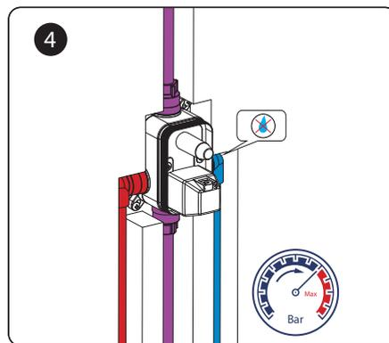
Проверьте все соединения на герметичность.
