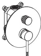
Поверните ручку дивертора в положение 12:00, для подачи воды в режим «тропический душ».
