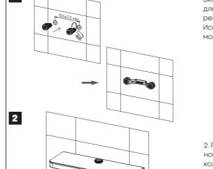
1. Установите в водорозетки эксцентрики, используя материал для герметизации водопроводных резьбовых соединений. Используйте входящий в комплект монтажный уровень.
