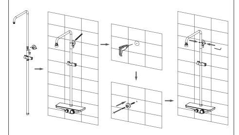
3. Соедините вертикальную трубу со смесителем и произведите разметку верхнего крепления трубы на стене. Прикройте смеситель во избежание повреждений. Просверлите отверстие в стене (D 8 мм, L 40 мм) используя подходящий тип сверла для данного типа облицовки. Установите крепление на стене и зафиксируйте на нем вертикальную трубу.
