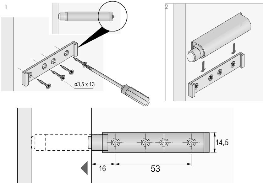
Монтажная планка толкателя устанавливается на боковине с левой стороны для пеналов с открыванием дверей вправо. Для пеналов с открыванием дверей влево - с правой. Для открывания ящика, толкатель ставится на полку под ящиком.
