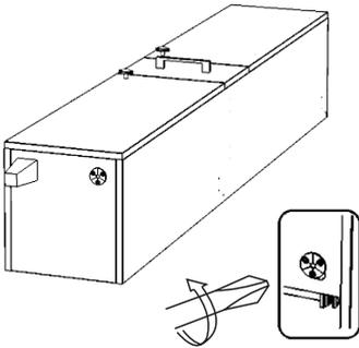
Установить крепежные пластины опор, крепеж саморез 4x16, предварительно сняв заглушки в местах крепления (вариант с декоративными опорами)
