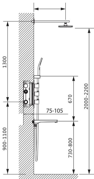
Определите точное место установки смесителя. Рекомендуем устанавливать смеситель на высоту 900-1100 мм от уровня пола. Подведите водопроводные трубы так, чтобы монтаж и демонтаж смесителя не вызывал затруднений. Убедитесь, что подача горячей воды слева, а холодной справа. Установите трубы в монтажную коробку. Смеситель устанавливается на глубину 75-105 мм от внешней поверхности стены.
